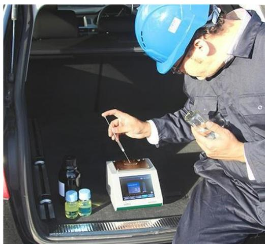
2月9日-Quantitech 发明一种新式可移动式红外线油水分析仪 - InfraCal 2。该分析仪能够提供新的功能，包括多元校正，探测限制少，快速分析，数据记录以及触屏设备。
