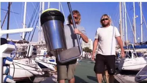
12月30号--来自西班牙的一队发明家设计一款自动式垃圾箱-能够收集漂在水面的垃圾，溢油，柴油和消毒剂。这款设备设计用于游艇码头水域漂浮码头，私人浮桥，内陆航道，港口和游艇俱乐部。
