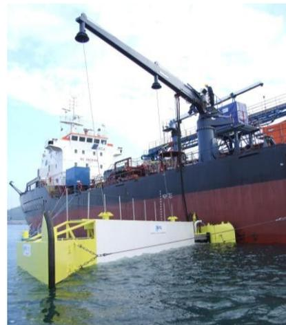
在恶劣的天气情况下仅需几名船员进行的溢油回收必须是快速有效，于此同时首先围控溢油然后回收溢油的传统方式耗费大量时间，由于大风和海浪因素浮油层不断移动。Koseq 公司生产的独立船舶回收系统能够在几分钟内置放完毕然后像胡佛电动吸尘器穿过浮油层进行溢油回收。例如，欧洲海事局相关信息显示 Koseq 生产的刚性扫油臂在 2012 年发生的“著名”溢油事故中的出色表现。
