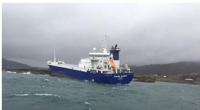
2月25号--根据英国 MCA，针对 2月18号搁浅的 Lysblink Seaways 号进行的船队柴油过驳作业准备于今天早上的某个时间开始。良好的天气情况意味着可以在凌晨 3 点到中午进行。总共 153 吨的柴油将从 Lysblink Seaways 号抽送到 Kingdom of Fife 拖船上。
